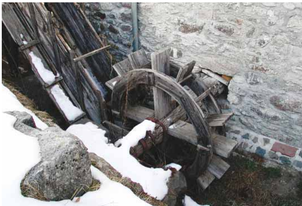
Fig. 15 – Casteons, Borg dai Fâris: ruota idraulica a palette degli opifici un tempo appartenuti alla famiglia Filippi.
